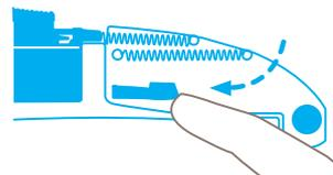
Libere el cargador de la hoja **presionando hacia abajo y empujando hacia delante**, como se indica.
