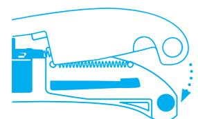
Finalmente, pliegue la **mitad superior del mango hacia abajo** hasta que se coloque en su sitio. Por favor, compruebe la retracción de la hoja!
