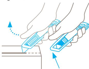
**Retroceso automático de hoja: alto grado de seguridad**
